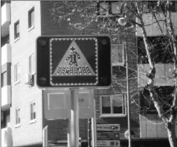
Aviso luminoso de paso de peatones
